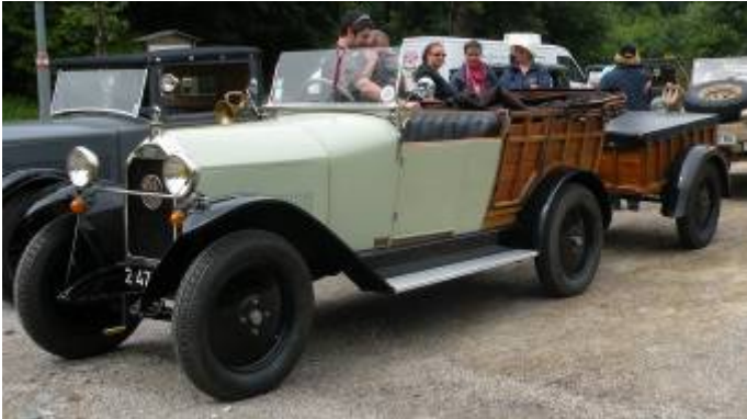
Mathis Typ M Normandie Baujahr 1924 4Zyl. Viertaktreihenmotor Wasserkühlung, 995ccm, 4 Gang, 4 Sitzer, Eigengew.: 880kg Einzigler leichter Anhänger von Mathis
